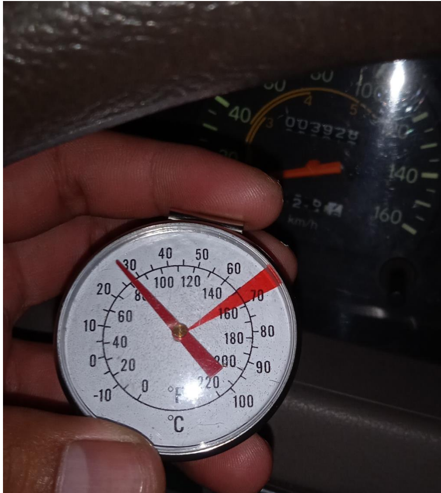
Gambar V.21 Pengukuran Suhu dalam Kabin dengan thermometer Analog
