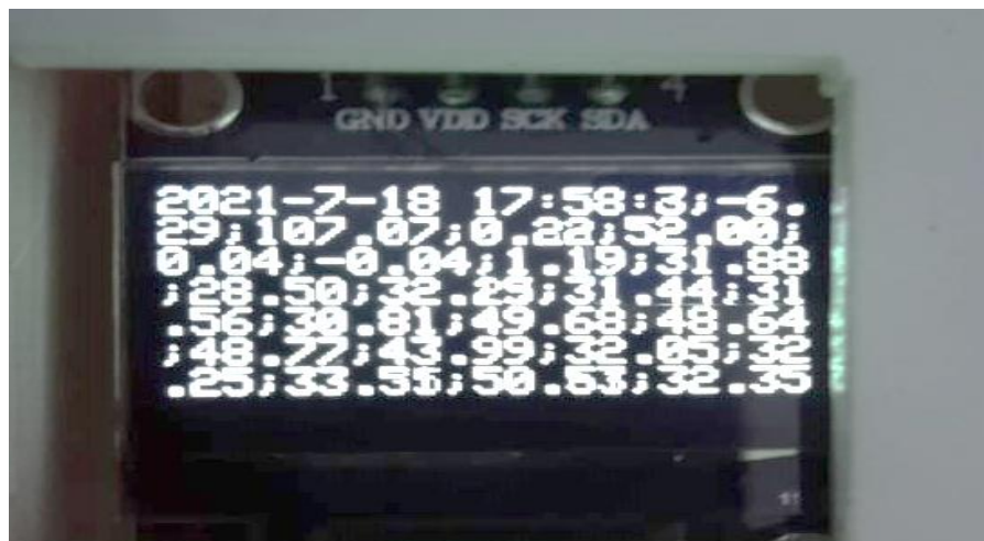
Gambar V.17 Visualisasi tampilan LCD memonitor kerja perekaman data logger
