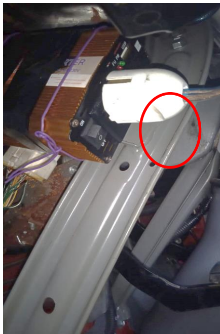
Gambar V. 15 Lokasi tombol ON-OFF Untuk catu daya Data Logger
