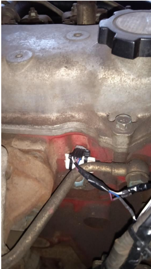
Sumber :Data Pribadi, 2021 Gambar V.7 Lokasi sensor suhu mesin
