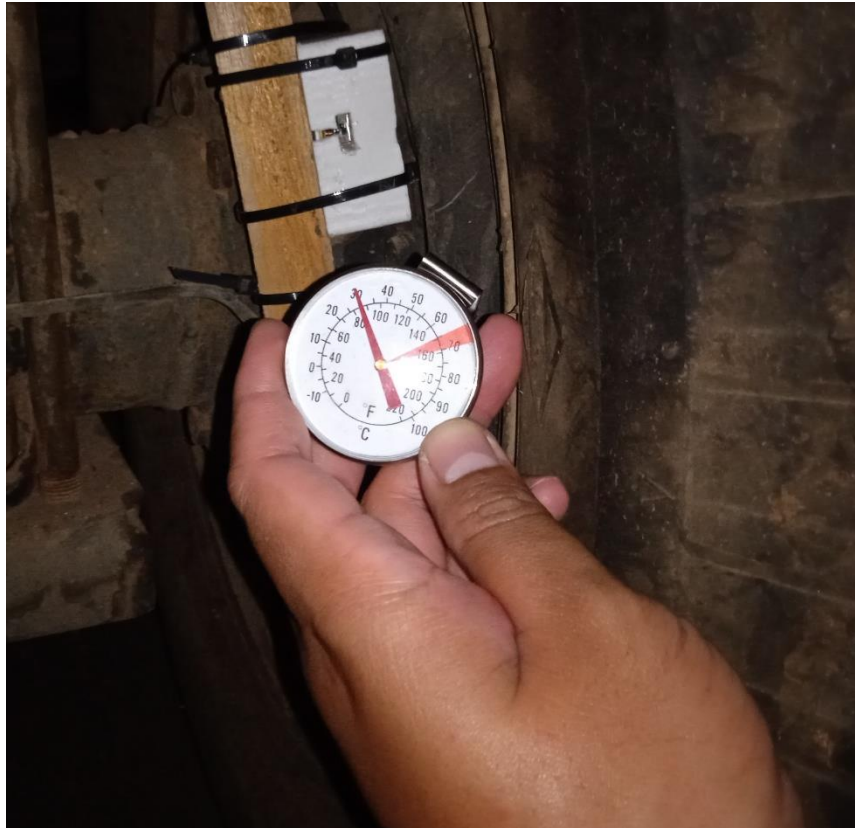
Gambar V.24 Pengukuran Suhu Rem dengan Thermometer Analog
