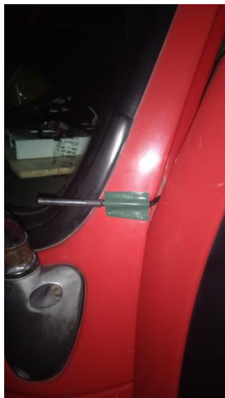
Gambar V.4 Lokasi Sensor suhu udara luar kabin
