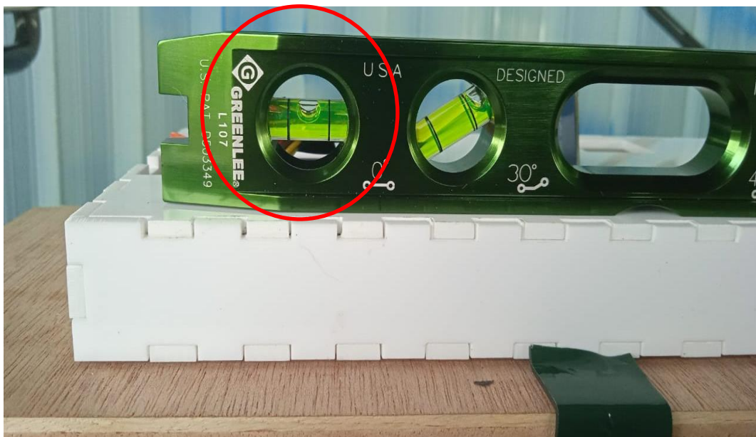
Gambar V.26 Validasi kesetimbangan dengan waterpass raksa sisi panjang
