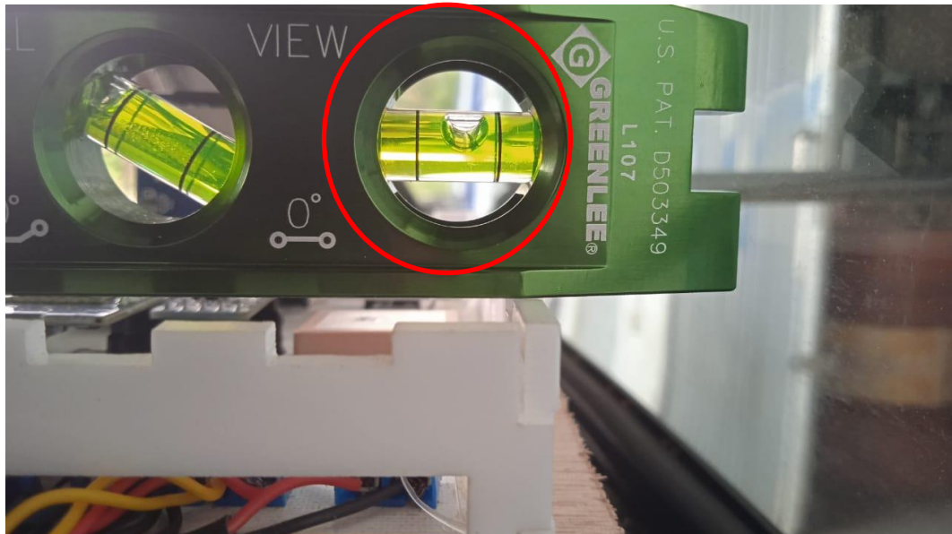
Gambar V.27 Validasi kesetimbangan dengan waterpass raksa sisi lebar
