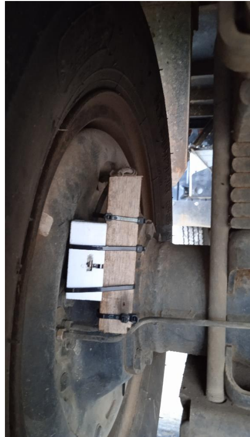
Gambar V.8 Lokasi sensor suhu rem C dan D
