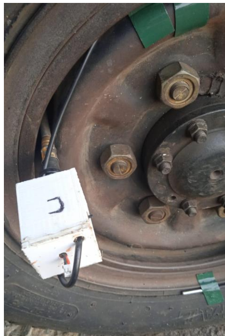
Sumber :Data Pribadi, 2021 Gambar V.9 Lokasi sensor suhu ban dan Tekanan ban
