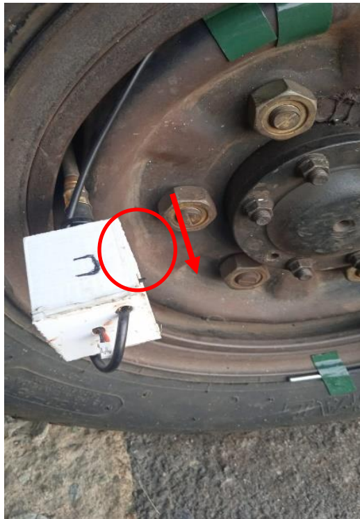
Gambar V.13 Modul Sensor untuk Suhu dan Tekanan Ban A,B,C dan D
