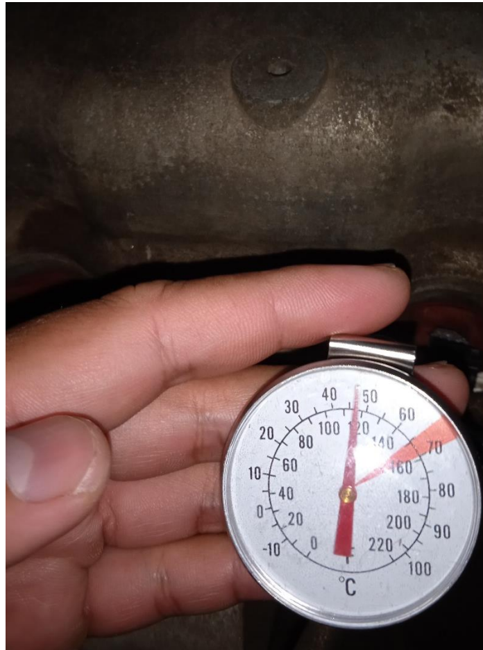
Gambar V. 25 Pengukuran Suhu Mesin dengan Thermometer Analog
