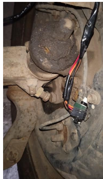
Gambar V.6 Lokasi sensor suhu Rem pada Roda A dan B
