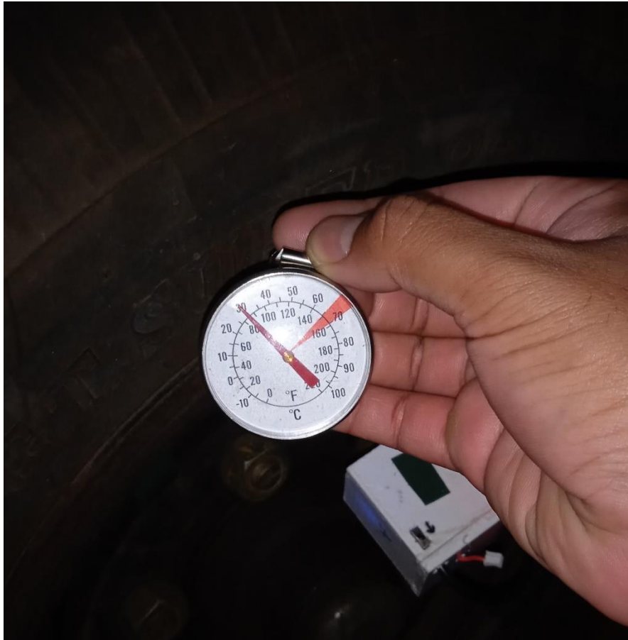
Gambar V. 23 Pengukuran Suhu ban dengan thermometer analog
