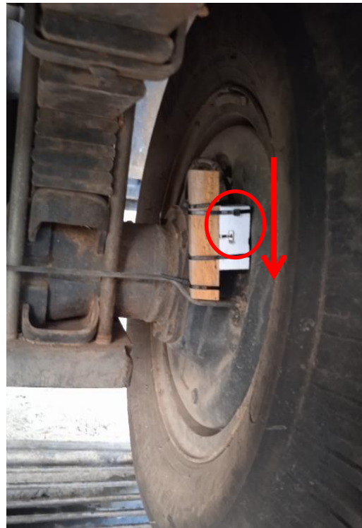
Gambar V.14 Modul Sensor untuk Suhu Rem Roda C dan D
