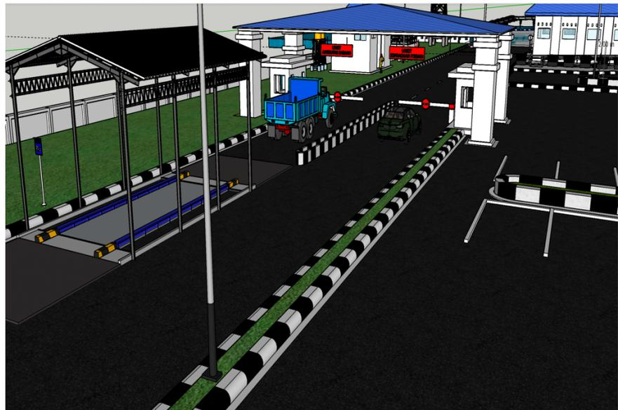
Gambar V.31 *Tollgate* dilengkapi Jembatan Timbang
