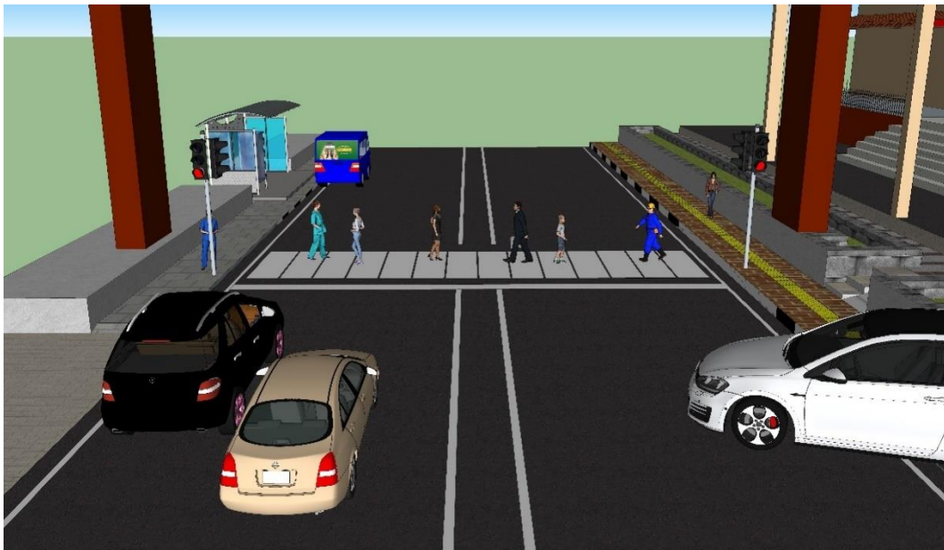
Gambar V. 27 Usulan Pelican Crossing dengan marka Zebra Cross Pada Jalan Pierre Tendean III
