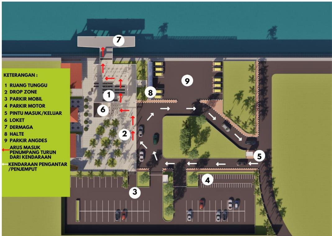
**Gambar V. 7** Pola alur penumpang naik dengan kendaraan pengantar
