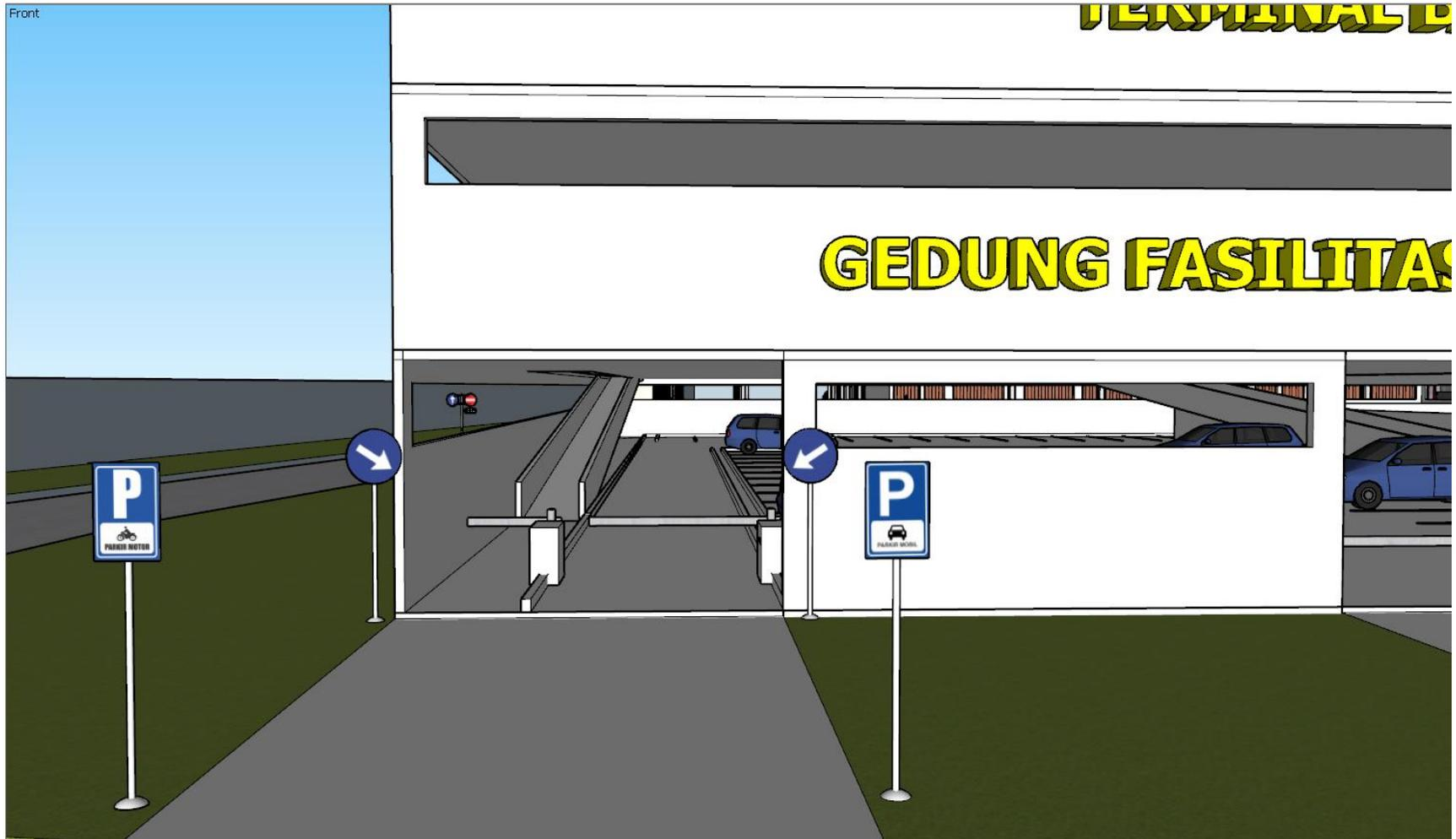
**Gambar V.23** Visualisasi Rampa Naik Sepeda Motor
