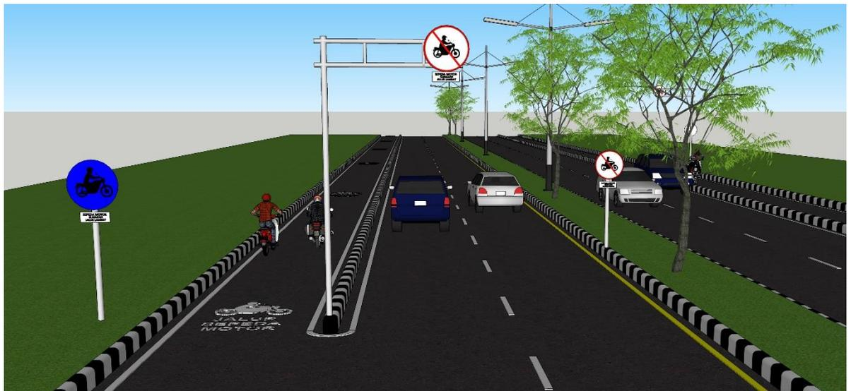
**Gambar V. 8** Visualisasi Lajur Sepeda Motor serta Peletakan Rambu
