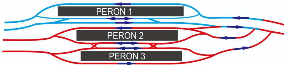
Gambar V. 4 Layout Emplasemen Stasiun Bekasi bentuk pulau
