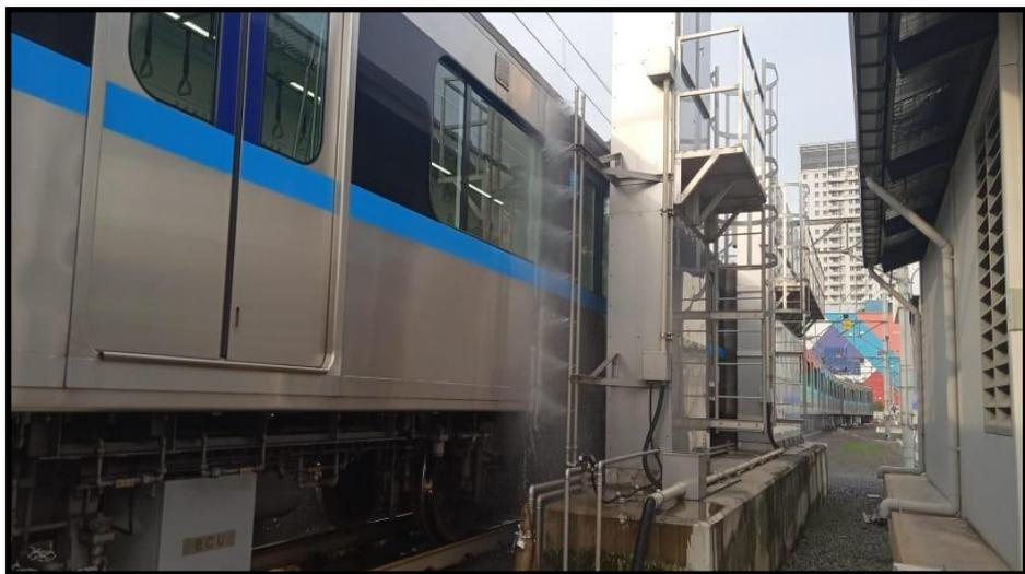
**Gambar V.9 Proses Pencucian Menggunakan Automatic Train Washing**
