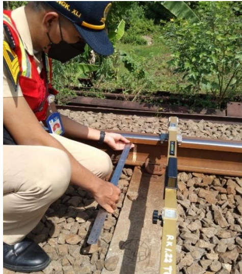
Gambar III.9 Pengukuran Opname Lengkung
