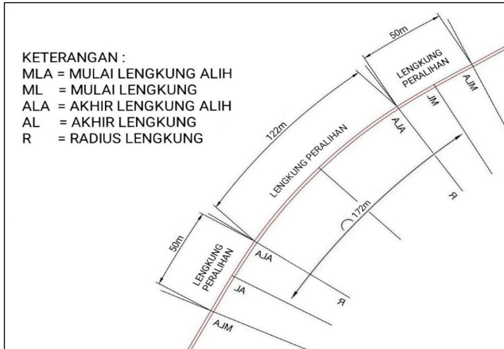
Gambar II.2 Lengkung IP 32 Km 48+591 - Km 48+763 Petak Jalan Cilejit-Daru
