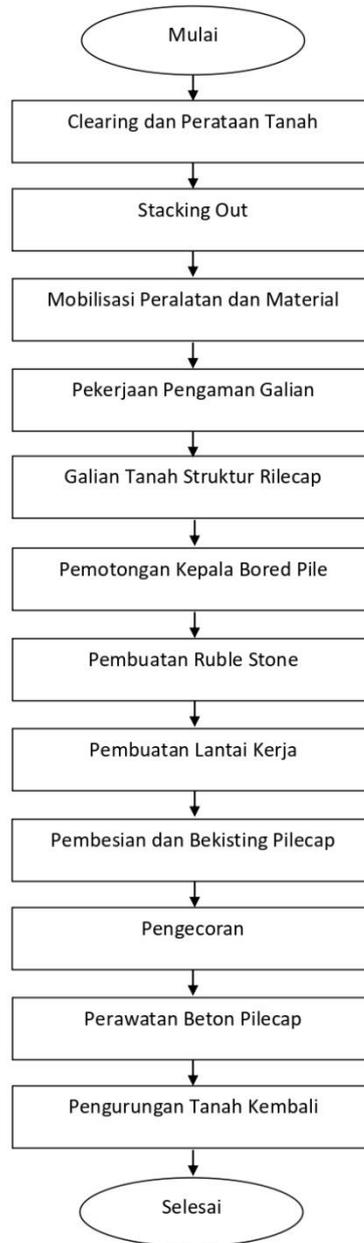
**Gambar V. 9** Bagan Alir Metode Konstruksi *Pile cap*
