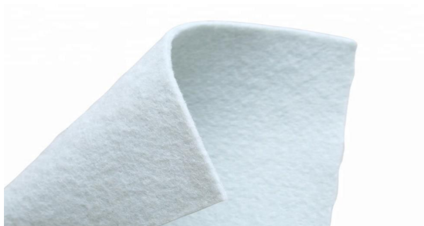
Gambar V.9 Bahan Geotekstile Non Woven
