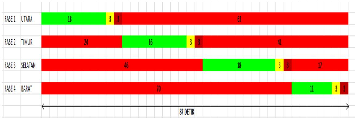
**Gambar V. 5** Diagram Waktu Simpang Semabung Usulan I
