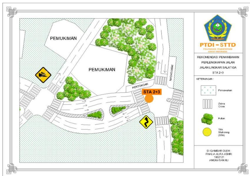
**Gambar V. 40** : Rekomendasi Titik Rambu STA 2+3
