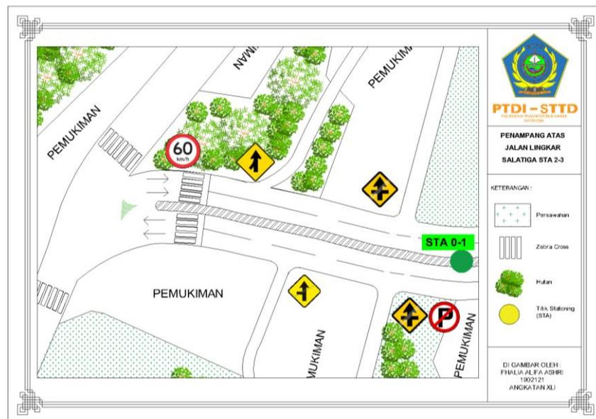
**Gambar V. 38** : Rekomendasi Titik Rambu STA 0+1
