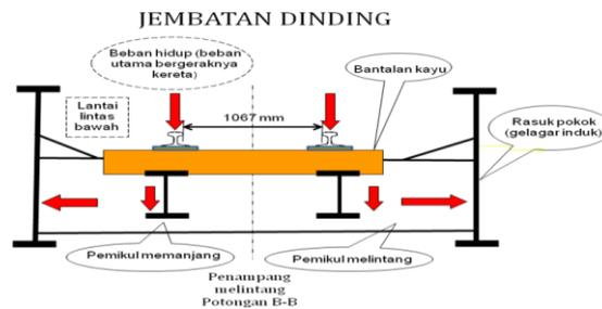
**Gambar 3.7** Komponen Jembatan Dinding.
