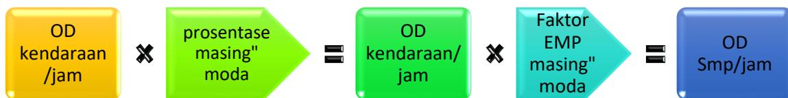
**Gambar V.2** Perubahan perjalanan/Jam Menjadi Smp/Jam
