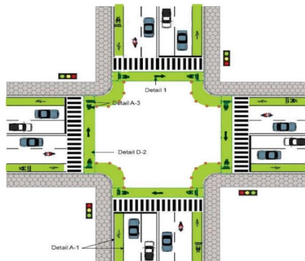
Gambar III. 5 Tampak atas lajur sepeda tipe C di persimpangan tanpa pulau jalan, dengan proteksi pada radius tikung dapat berupa stick cone ataupun perkerasan beton
