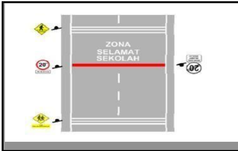
Gambar III. 4 Pemasangan Pita Pengaduh
