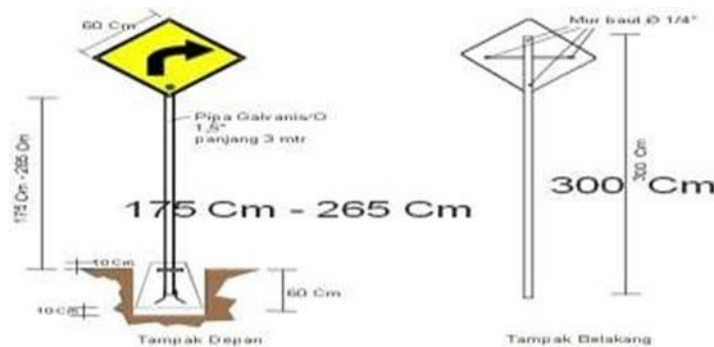
Gambar III. 1 Keterangan Pemasangan Rambu
