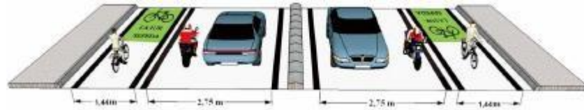
Gambar III. 4 Kondisi lebar lajur untuk jalan kecil
