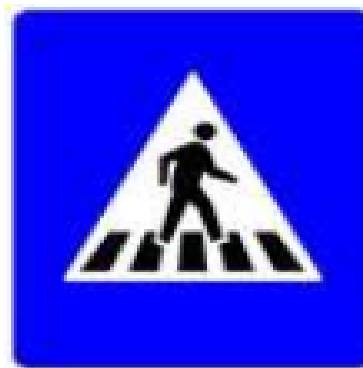
Gambar III. 12 Rambu Petunjuk Lokasi Fasilitas Penyeberangan Pejalan Kaki
