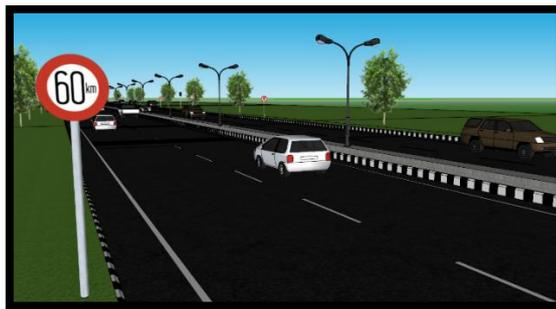
**Gambar V. 30** Rekomendasi Pemasangan Rambu Batas Kecepatan
