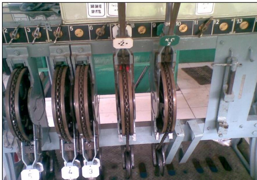
Gambar.II. 8.Peralatan dalam Persinyalan Mekanik (Perkakas Hendel)
