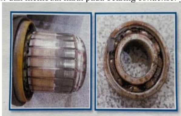
**Gambar III. 4** Bearing Condenser Fan Berkarat
