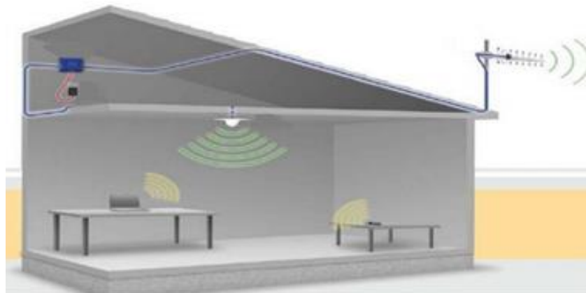
Gambar V. 11 Pemasangan Repeater Indoor Gedung
