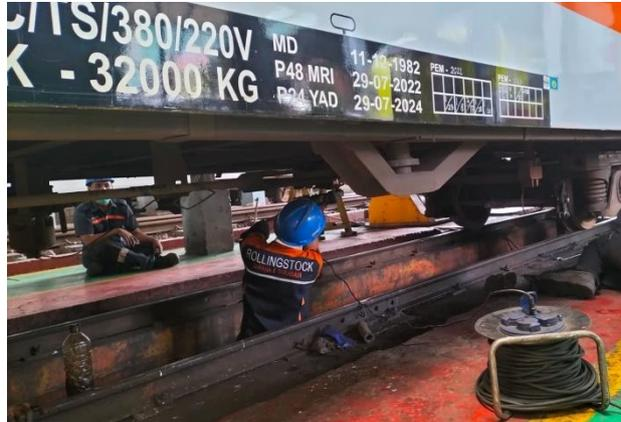
**Gambar II. 4** Perawatan Rangka Bawah Pada Perawatan Bulanan
