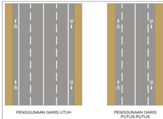
**Gambar III. 2** Marka Jalan Jalur Sepeda
