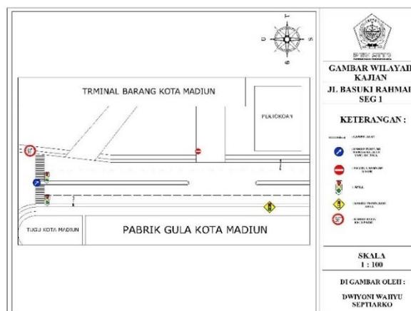
2. **Gambar 16.** Usulan Penempatan Fasilitas Perlengkapan Jalan Segmen 1
