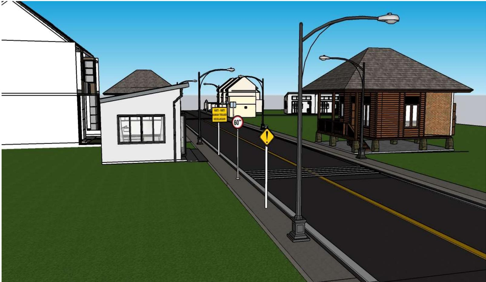
**Gambar V. 43** Usulan Fasilitas Perlengkapan Jalan Pada Ruas Jalan Surabaya – Situbondo KM 104 Segmen 3
