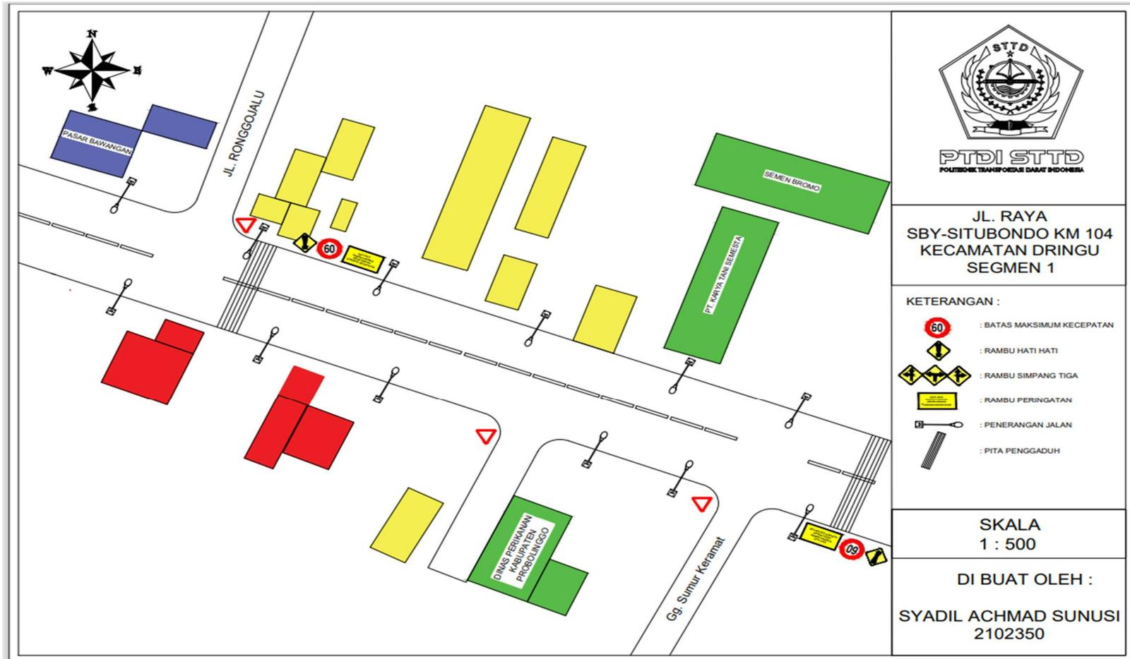
**Gambar V. 36** Usulan Fasilitas Perlengkapan Jalan Pada Ruas Jalan Surabaya – Situbondo KM 104 Segmen 1
