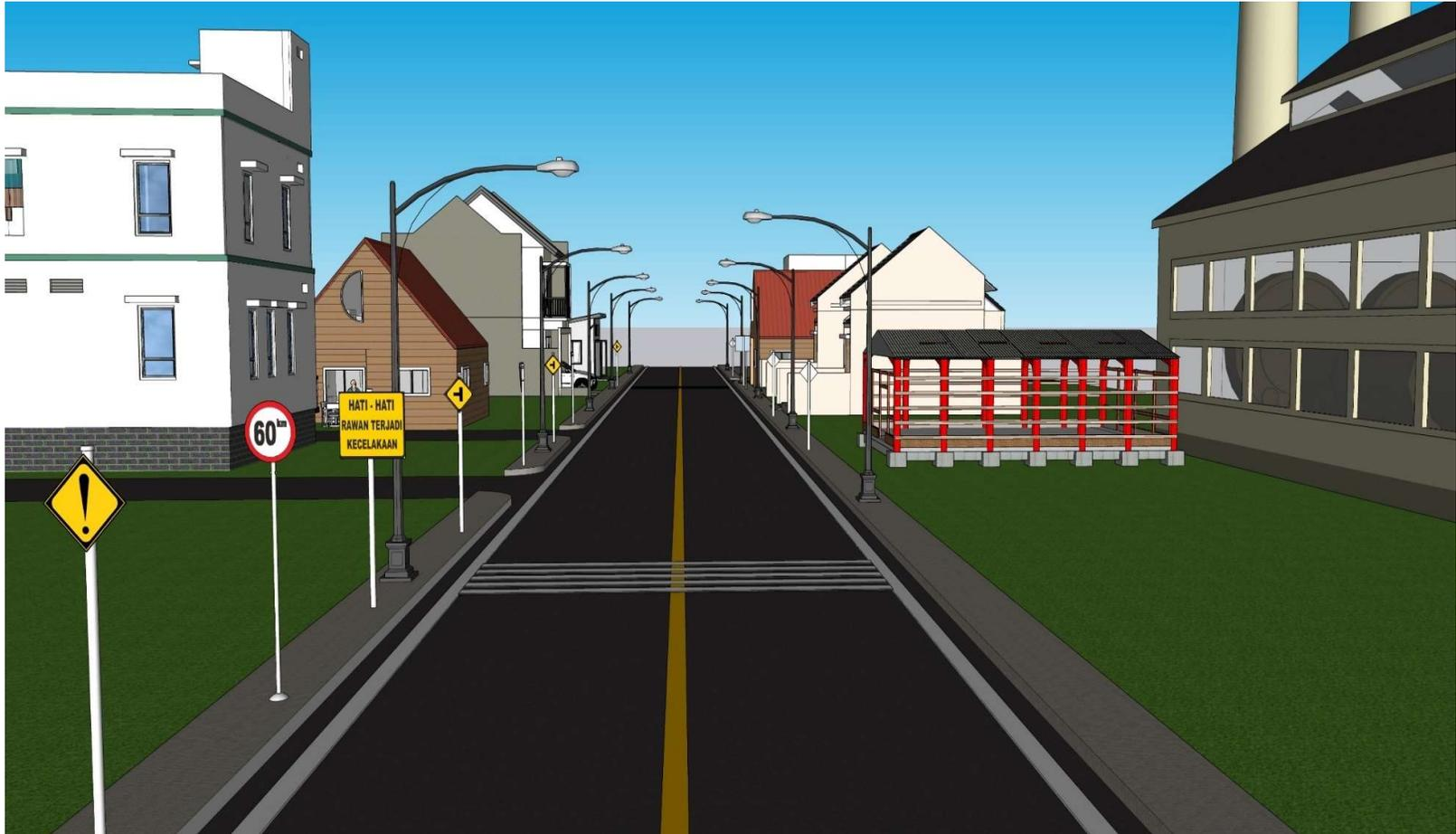
**Gambar V. 37** Usulan Fasilitas Perlengkapan Jalan Pada Ruas Jalan Surabaya – Situbondo KM 104 Segmen 1
