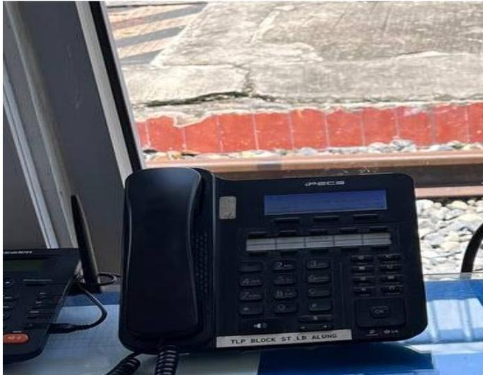
**Gambar II. 15** TOKA (Telepon Otomatis Kereta Api)
