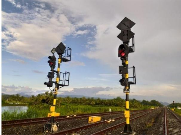
**Gambar II. 12** Peraga Sinyal Elektrik SILTrack LS3000
