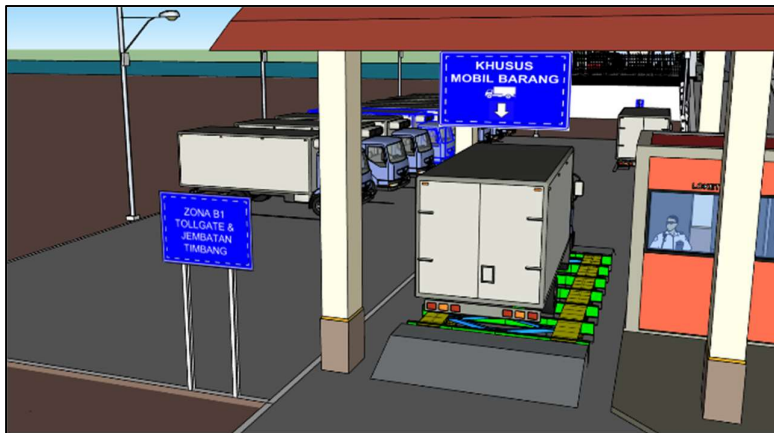
Gambar 3. Rencana Penempatan Jembatan Timbang
