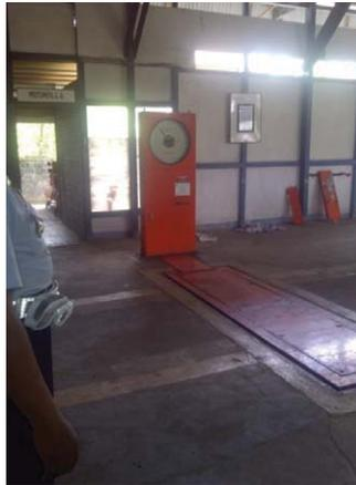
Gambar 4.24 Axle Load Weight Beam milik UPTD Pengujian Kendaraan Bermotor Kota Pontianak
