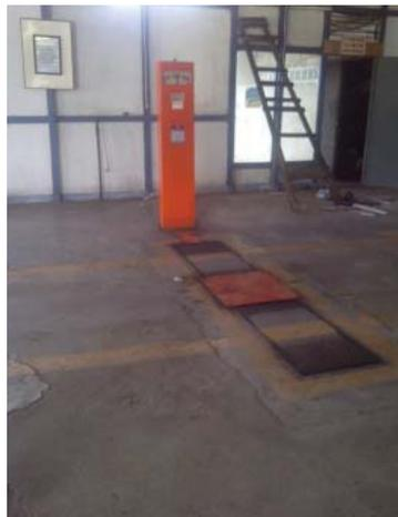
Gambar 4.22 *Side Slip Tester* milik UPTD Pengujian Kendaraan Bermotor Kota Pontianak
