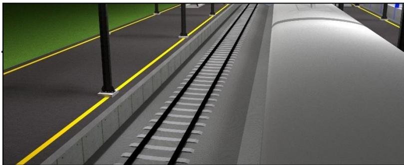
**Gambar V. 14** Rencana Fasilitas Keselamatan berupa safety line min.35 cm dari tepi peron dan lampu penerangan pada peron
