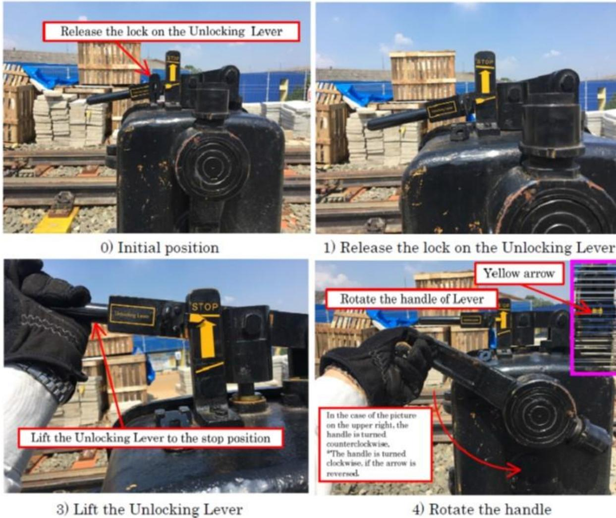
Gambar 4 Operasi secara normal
